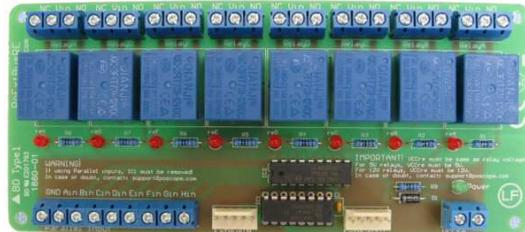
Die Buserweiterung *PoBusExtRe* für das PoKeys-System (PoKeys-55T, PoKeys-56T und PoKeys-57T) ermöglicht es, zusätzlich 8 Ausgänge (Relais, 12V, Wechsler) anzuschliessen. Die Leistungsausgänge können Lampen, Relais, Ventile oder ähnliche Lasten ansteuern.
