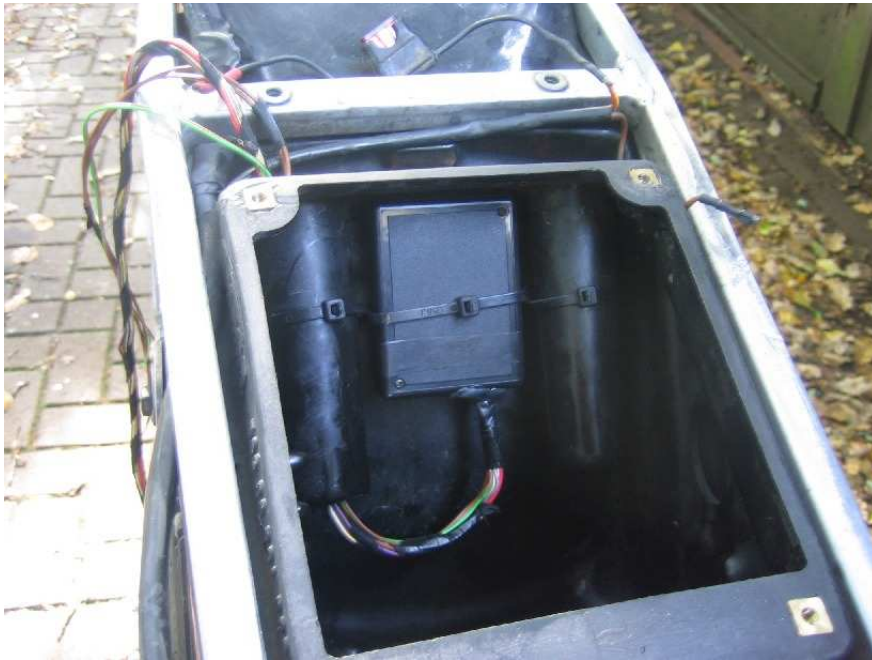
Fertig installierte Box im Luftfilterkasten. Die Kabelbinder fixieren dabei alles, funktioniert sehr gut und vibriert fast nicht.
