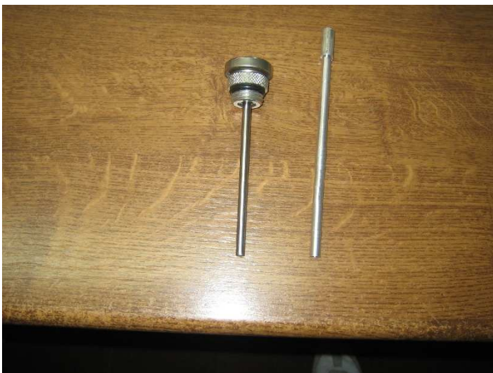
Ölthermometer von MD, daneben abgedrehter Stab aus Alu
