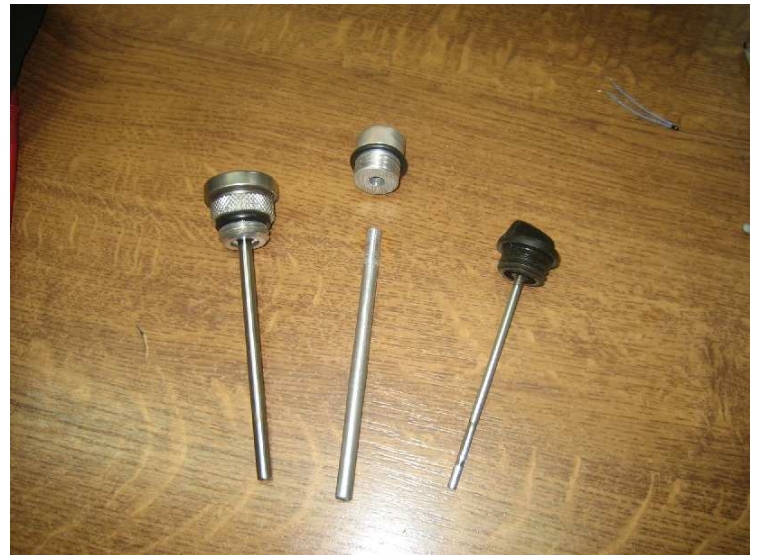
Links: MotoDetail Einschraubthermometer Mitte: Fertiger Stab mit Außengewinde, Oberteil mit O-Ring und Bohrung mit Innengewinde Rechts: Originaler Peilstab
