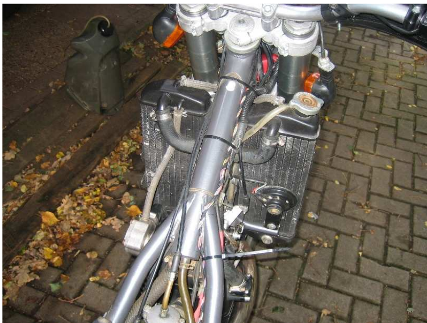
Kabel am Oberrohr nach vorne gelegt und mit Kabelbindern fixiert
