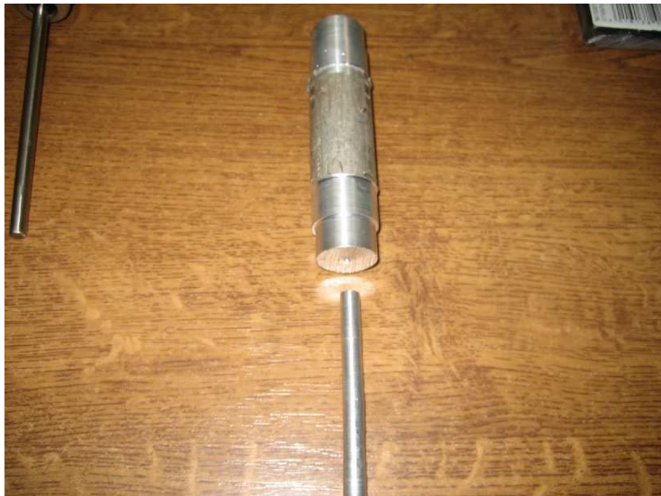
Ober- und Unterteil ohne Gewinde
