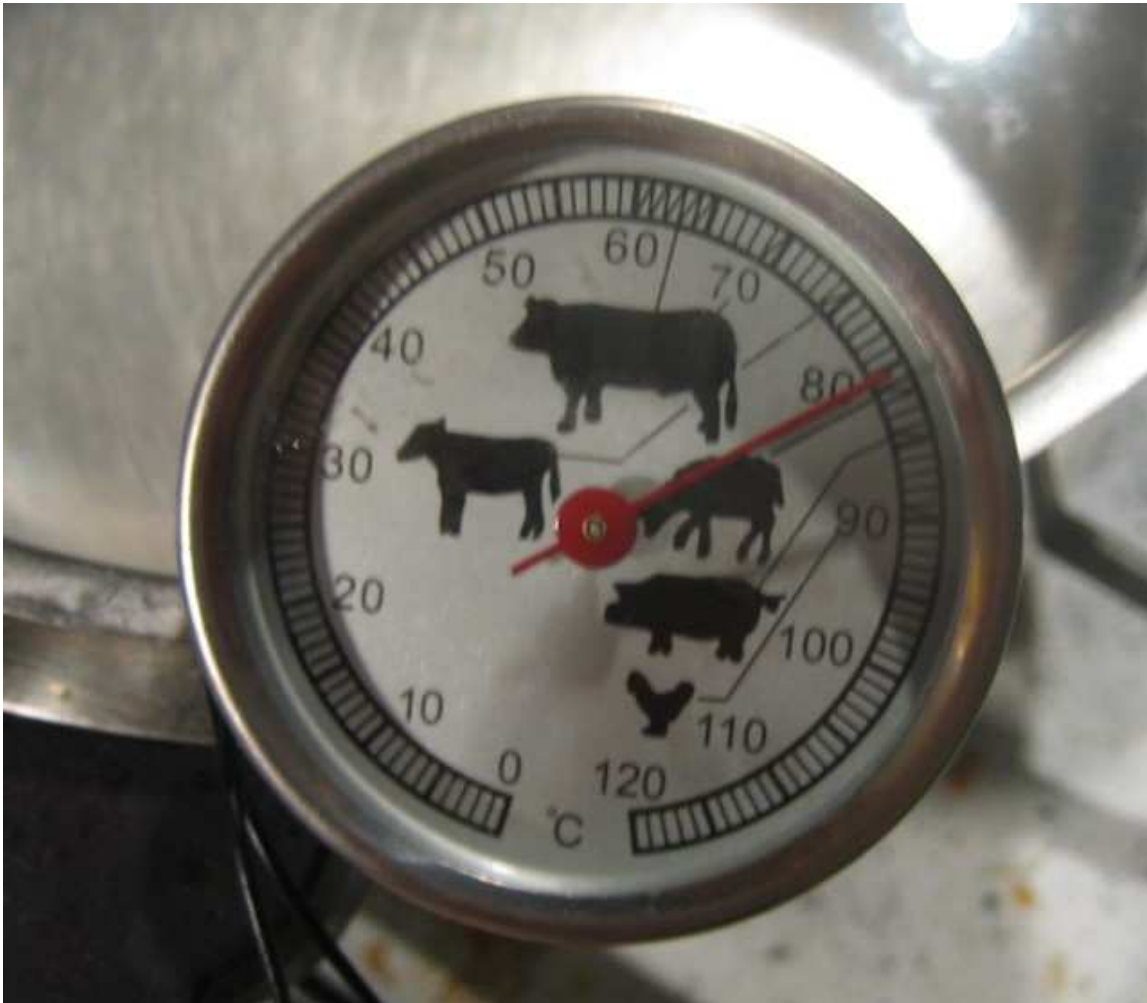
Bratenthermometer im Wassertopf (steht der Zeiger auf „Lamm“, ist der Motor warm!)
