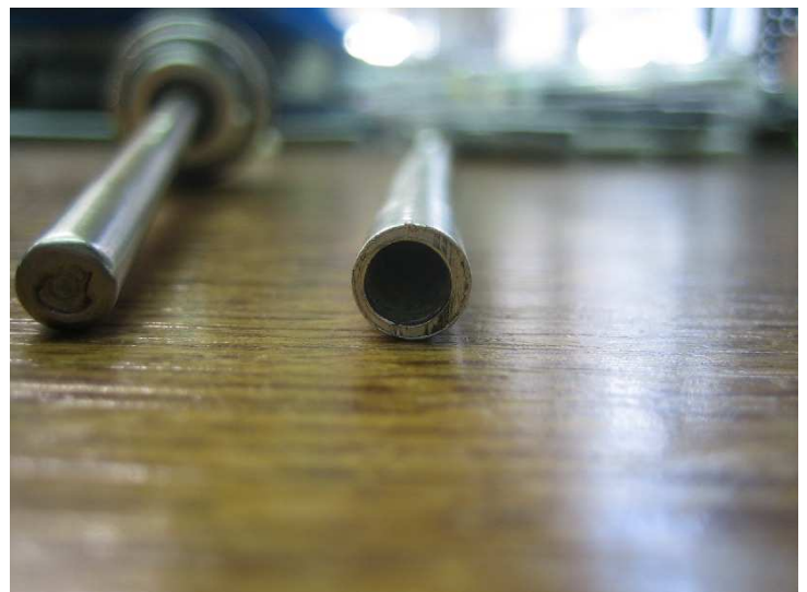
Stab (fast) mittig bis zur Hälfte durchbohrt
