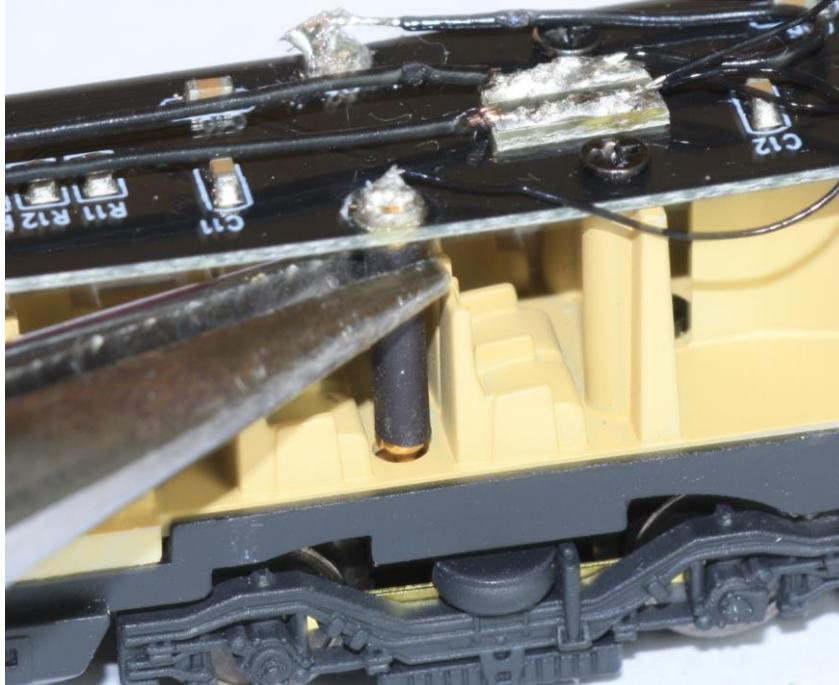
Zwischen den beiden Schrauben ist wieder sehr gut die kleine Zusatzplatine zu erkennen. Nach rechts gehen die Kabel zur Kupplung und zu den Lötunkten, nach links die zu der Platine am anderen Wagenende. Schließlich soll ja eine Stromabnahmebasis durch den ganzen Zug entstehen.
