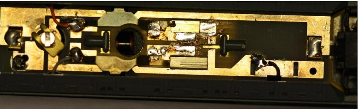
Das dritte Bild zeigt den eingebauten und angeschlossenen Decoder.
