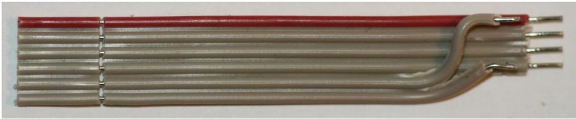
Zuerst werden die beiden kürzeren, danach die vier längeren Drahtenden auf dem Decoder festgelötet. Zur Sicherheit wird auf die vordere Löt pad-Reihe ein Stück Tesafilm zur Isolierung eingefügt.
