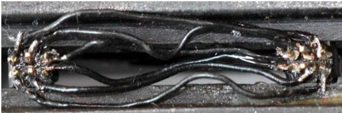
Die jeweils äußeren Stiftpaare werden gekürzt, das in der Mitte bleibt lang. Dies dient als "Griff" beim Einsetzen oder Herausziehen des Steckers. Wenn alles kurzschlussfrei ist, wird auf die Lötstellen eine Schicht Nagellack aufgetragen, der hier als Isolierschicht dient. Dann werden die Kabel in Form eines U gebogen und die Stecker in die Buchsen eingesteckt.
