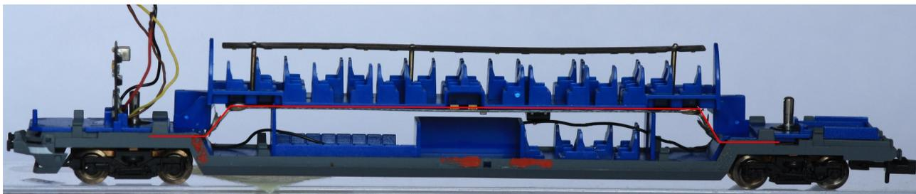
Links im Bild sieht man die abgetrennten Kabel der Spitzen-/Schlußlicht-Platine.
