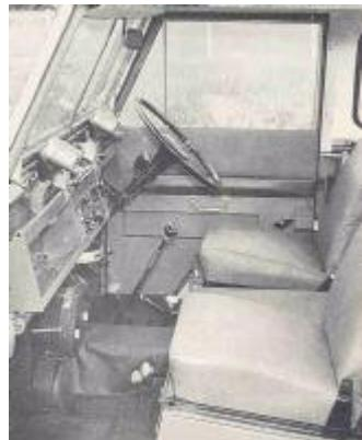
Der Serie IIA Schalthebel war auf dem Fußboden, zwischen dem Tunnel und dem Handbremsehebel. Der Serie IIB Hebel befand sich zwischen den Sitzen.
