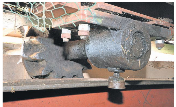
Das Bild zeigt das Zahnrad, das im Normalfall auf dem Zahnkranz liegt und von der Windrose angetrieben wird.
